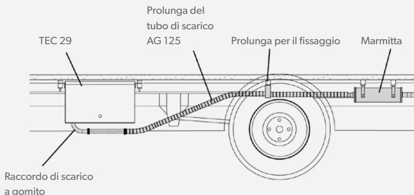
Utilizzare il tubo flessibile in metallo (2 metri in dotazione con la marmitta) per il montaggio del tubo di scarico. Ulteriore prolunga del tubo di scarico (AG 125) disponibile come optional. Tutti i componenti mostrati sono compresi nella dotazione di TEC 29 / TEC 29LPG.
